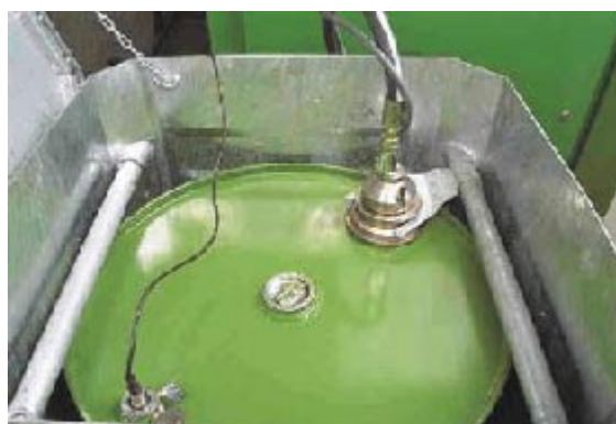
Přečerpávání použitého rozpouštědla
